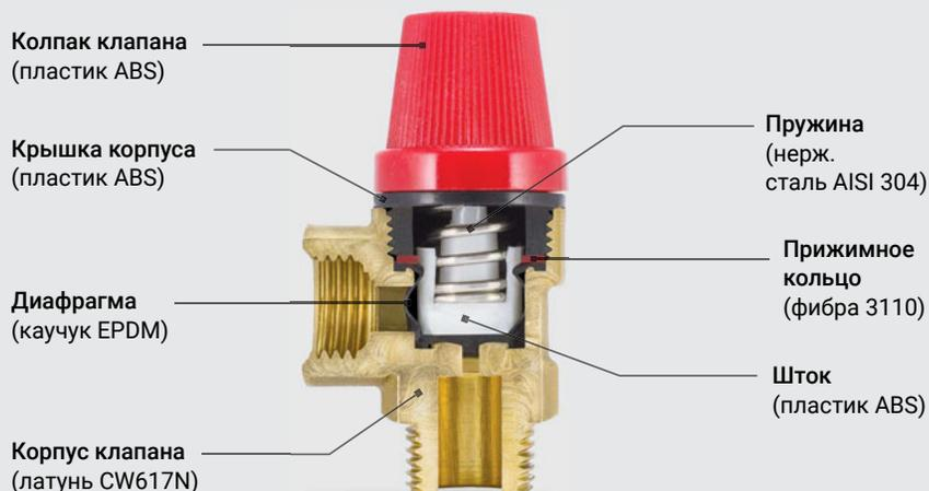
Предохранительный клапан предназначен для защиты паровых или водонагревательных систем от превышения максимально допустимого рабочего давления. При превышении давления в системе сверх допустимого клапан производит частичный сброс рабочей среды в атмосферу или в отводящий трубопровод.
